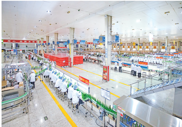
在西凤酒现代化包装生产车间内，工人们正在自动化灌装生产线上有序开展白酒检验、瓶装、封装作业。
