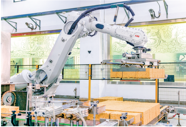
在西凤酒智能化酿造车间内，工业机械臂自动完成酒坯转运码垛作业。
