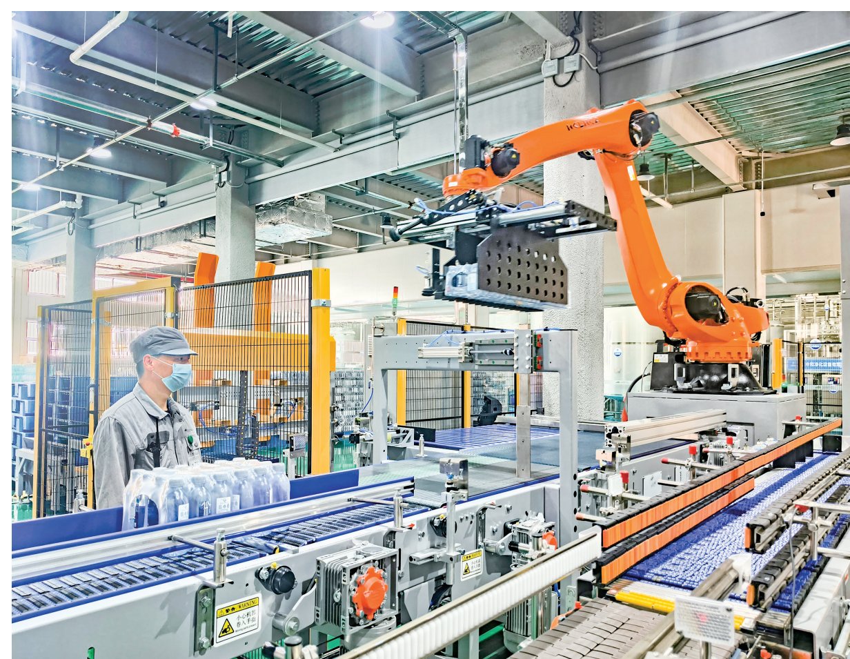
4月15日,陕西山川纪饮用水有限公司运用自动化机器人对成品包装饮用水进行码垛作业,生产效率较传统方式提升4至6倍。据了解,该企业位于宁陕县江口镇沙坪村旬河包装饮用水产业园,预计年产达4500万瓶(桶),带动当地20余名群众就业增收。
