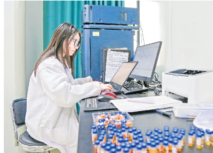
实验室学生正在使用高效液相色谱测定丹参根部的有效物质含量。
