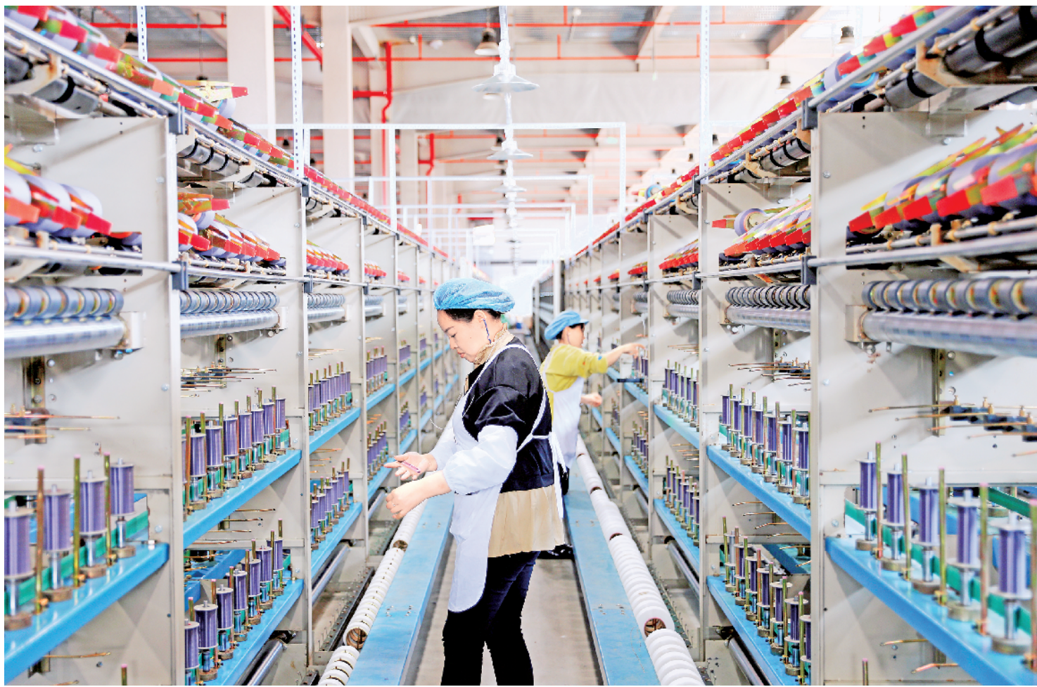
在石泉县袜业纺织产业园建设项目建设车间,纺织机和织袜机开足马力,成品纱线和丝袜裤产品等待发往市场。该项目总投资1.4亿元,新建年产600吨包覆纱、1600万条丝袜裤生产线和500万双童袜及350吨粗旦包缠纱生产线。项目采用差别化纤维包覆技术,各类包覆纱产品广泛应用于服装、内衣、口罩等针织品生产,预计实现年产值1.6亿元,带动就业300余人。图为工人在建设项目建设车间生产线上作业。 许兵 摄
