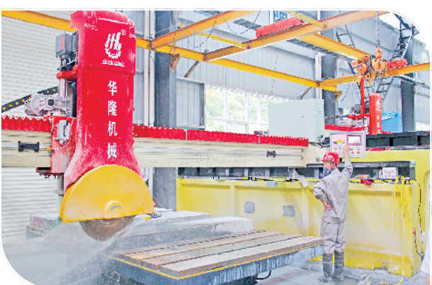
赛乐石业生产车间内工人正在操作机器切割石材
