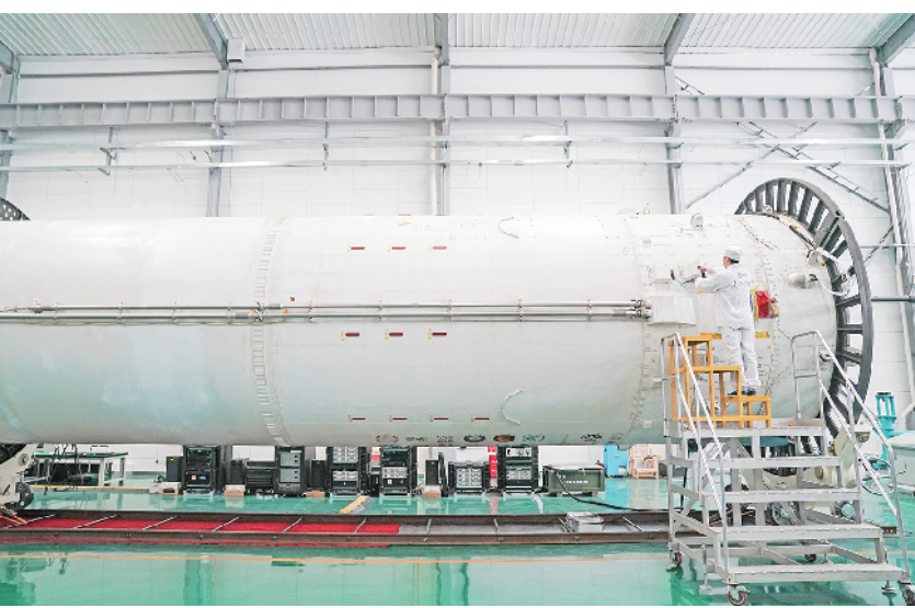
2月28日，在北京星际荣耀空间科技股份有限公司，装配测试人员在回装测试口盖。该公司积极转化科研成果，在可重复使用液体运载火箭等领域投入自主研发力量，在商业航天运载火箭领域不断取得新突破。
