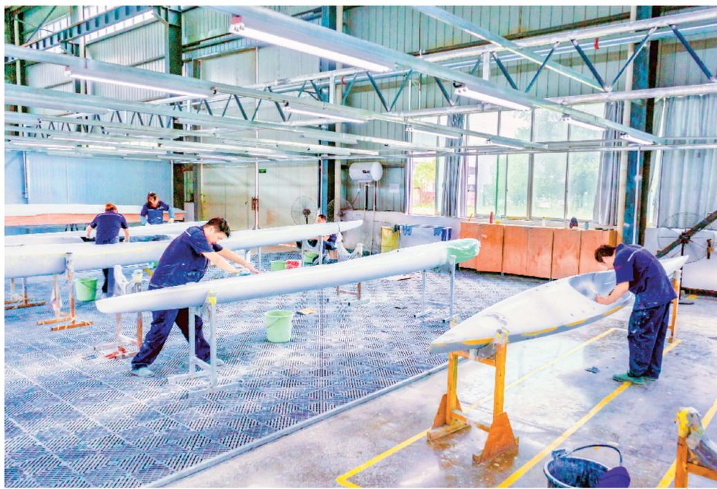
走进汉阴县年产3000条皮划艇项目生产线，工人们正熟练地手工打磨皮划艇，为最后的成型做准备。目前，该项目已建成皮划艇生产线3条。
