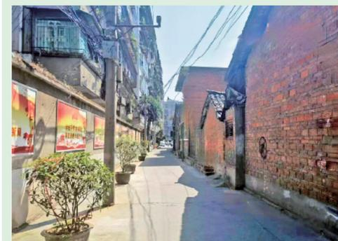
土地楼巷改造前的旧貌，空中线缆缠绕杂乱，土墙有雨水侵蚀的霉渍痕迹，路面年久失修变得坑坑洼洼。
