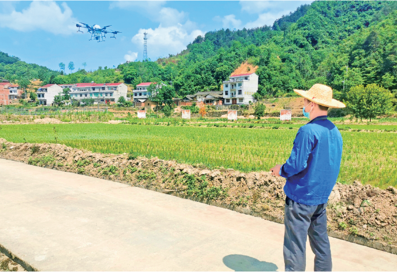
近日，汉滨区大河镇先锋社区水稻种植田上空，1架植保无人机正在飞手熟练的控制下进行施肥作业。不到1小时，100亩稻田的化肥喷洒工作就已完成。黄维摄
