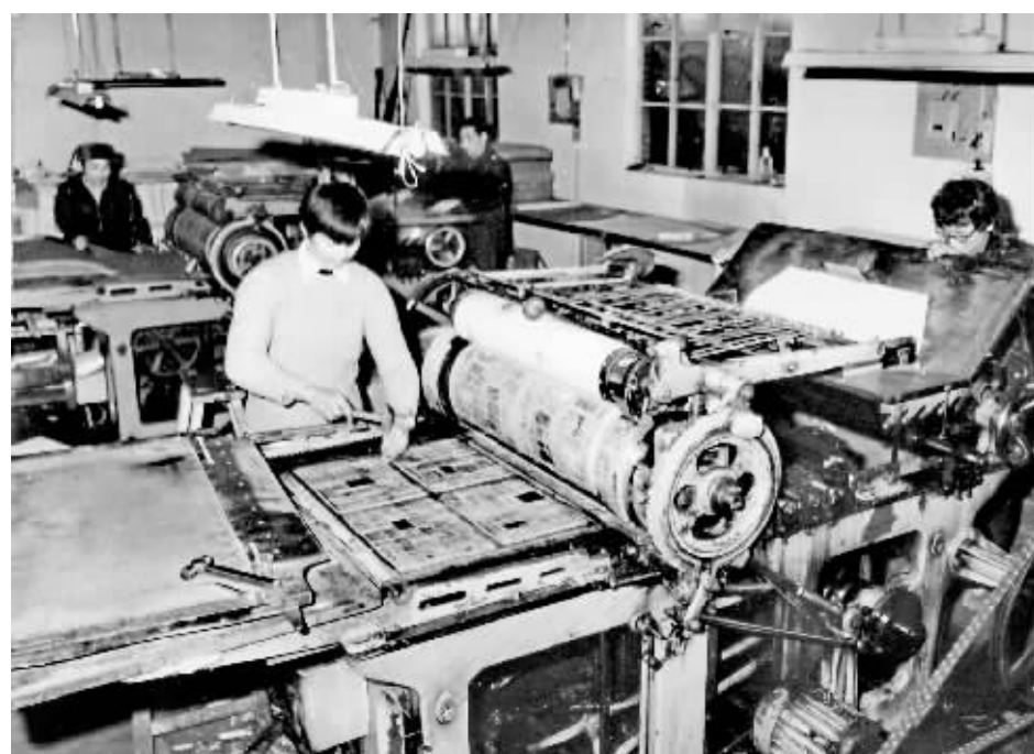
报社的印刷厂机印车间内,工人们正在为第二天的报纸忙碌着。当年的报纸是用对开印刷机人工一张一张的印刷出来的,是半自动化的设备。从上世纪五十年代初到九十年代的报纸都是这样的机器印出来的。
