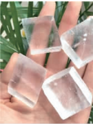
冰洲石是碳酸钙的晶体，具有最大的双折射功能和最大的偏光性效果，是已知物质中不能人工制造和无法替代的天然晶体。
