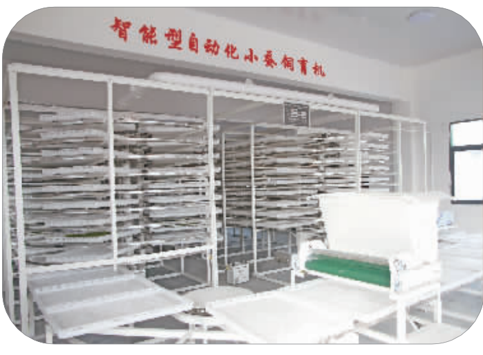
智能型自动化小蚕饲养机,可自动添食桑叶、打药消毒防病、调节温度、湿度、风速,只需1人操作,一次性可养蚕200张,养蚕劳动力效益可提高10倍以上。
