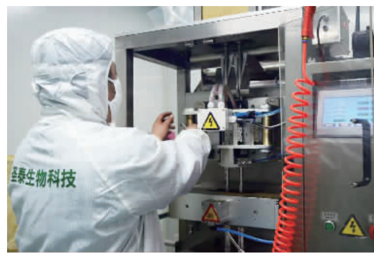
圣泰公司员工正在调试茶制品灌装线
