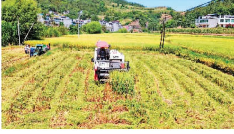
日前，旬阳县仙河镇苏陕协作订单种植水稻基地开始收获，图为农机工作者正在使用久保田688Q型联合收割机作业。据悉，目前全市共有久保田系列收割机12台，可对小麦、水稻等谷物类作物进行联合收获，质量可靠、作业效果好、损失率低，在丘陵山地每小时可作业3—5亩。
