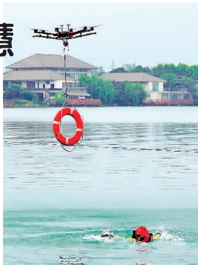
消防救援无人机挂载救生圈进行救援。人民视觉 岳建文 摄
