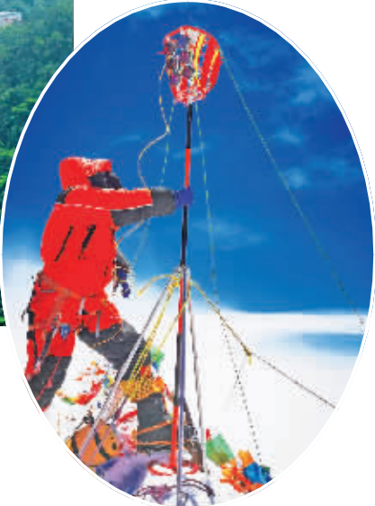
2020珠峰高程测量登山队员在珠穆朗玛峰峰顶开展测量工作(5月27日摄)。据自然资源部第一大地测量队队长李国鹏介绍，本次测量同时参考四大导航系统，并以北斗的数据为主。
